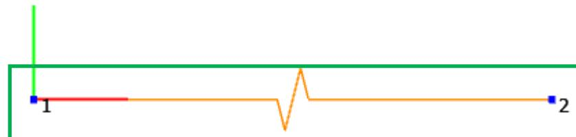
Il macroelemento deve essere posizionato fra pareti CLTwall, e non può essere usato da solo perché labile. Per facilitare il posizionamento, dividere il CLTwall originale mediante il comando *Modifica / Dividi e unisci*.
